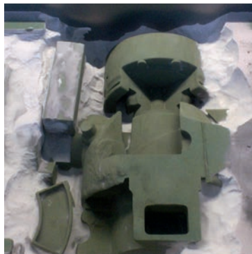
Le moule de la pièce a été réalisé par fabrication additive à l'aide d'une imprimante 3D.
